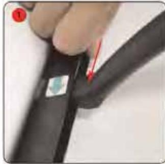
1 Faire coulisser l'extrémité du pied stabilisateur le long du rail inférieur dans le sens de la flèche verte, jusqu'à ce qu'il soit au milieu du rail.
