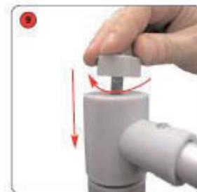
Attacher le mât horizontal au mât télescopique à l'aide de la vis fournie.
