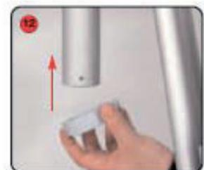
Positionner le stop anneau sur le mât télescopique avant d'emboîter ce dernier dans le pied.
