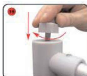
Attacher le mât horizontal au mât télescopique à l'aide de la vis fournie.
