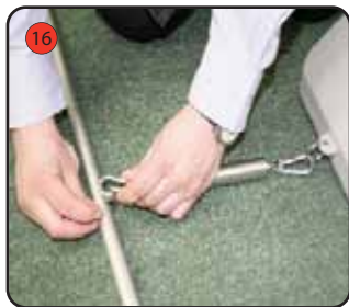
Attacher l'autre extrémité du ressort sur l'anneau du mât à élastique.
