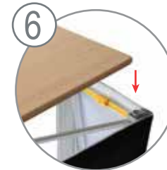
Positionnez la tablette sur la structure et l'étagère interne
