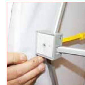
Fixation du visuel par velcro
