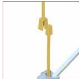
Ne pas soulever la structure par les connecteurs mais par le cadre
